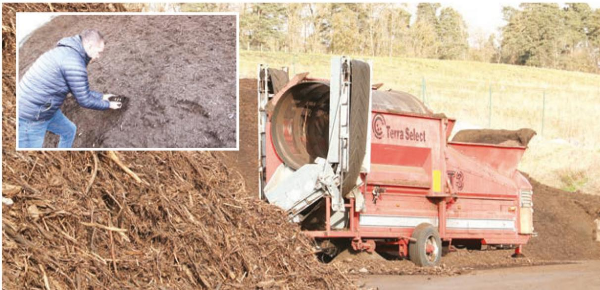
Le criblage permet d'extraire les dernières impuretés et de proposer un produit homogène.
